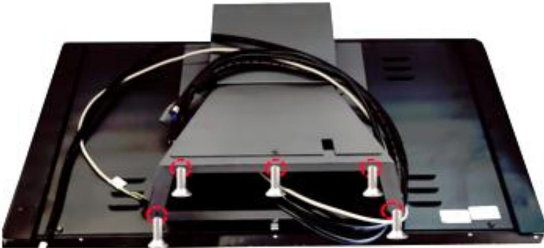
Fig. 19 Ubicación de los tornillos para fijarlos a la máquina
