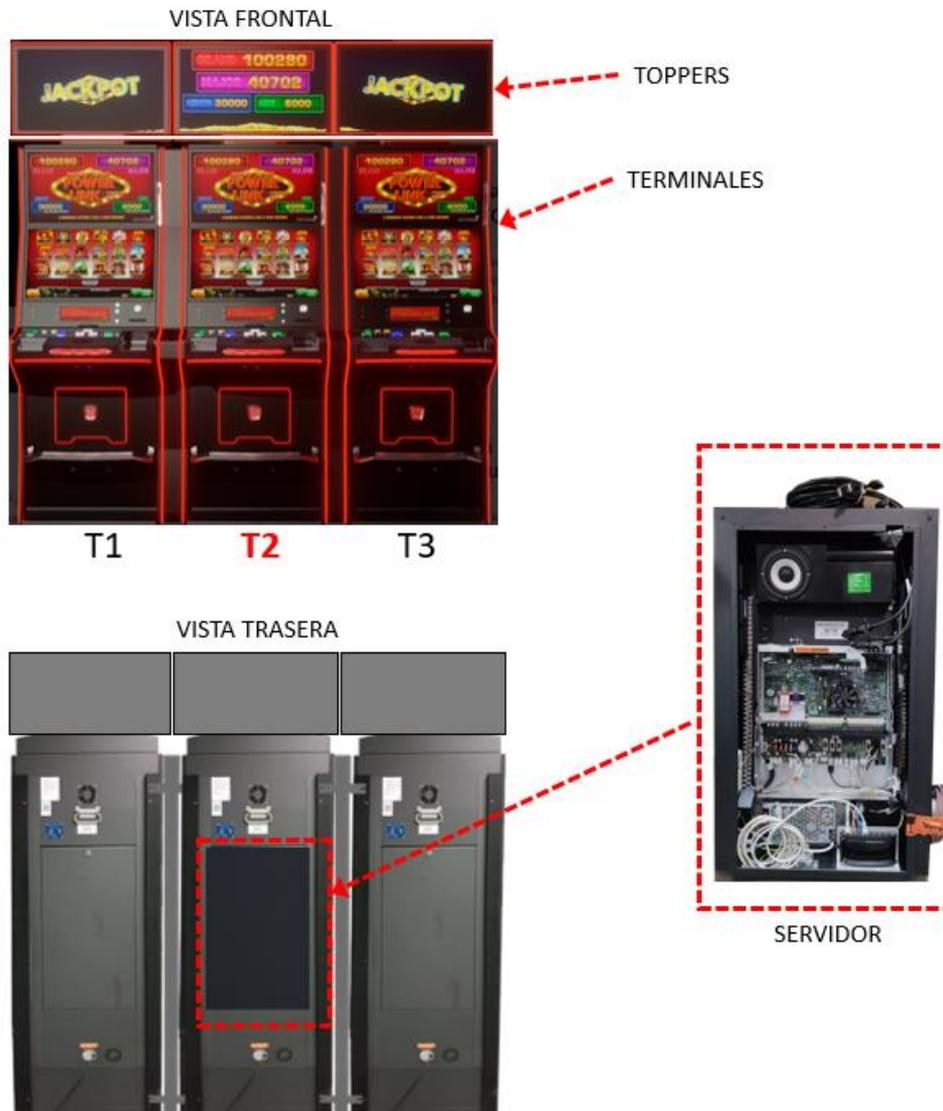
Fig. 9 Estructura del Sistema
